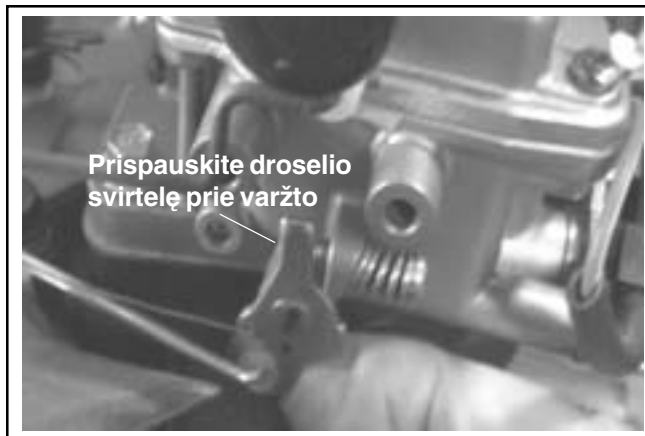
18 pav. Droselio svirtelės laikymas prispaudus prie tuščiosios eigos sustabdymo varžto
